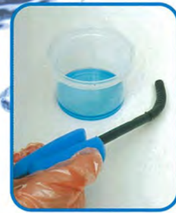
3. Schritt Reinigen Sie den Einführungsteil mit dem Schwamm
